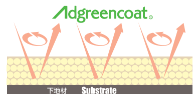
下地材 Substrate 躯体により即時に温度の低い外部に排熱 Reflect and release heat to where the heat from.
